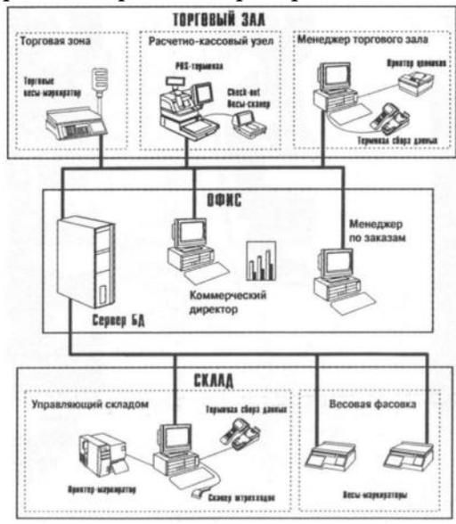
Рисунок 1 - Вариант функциональной схемы автоматизации супермаркета
